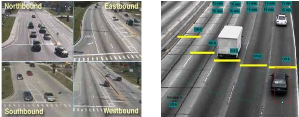
<그림 9> CCATS 방식의 차량 검지 화면
